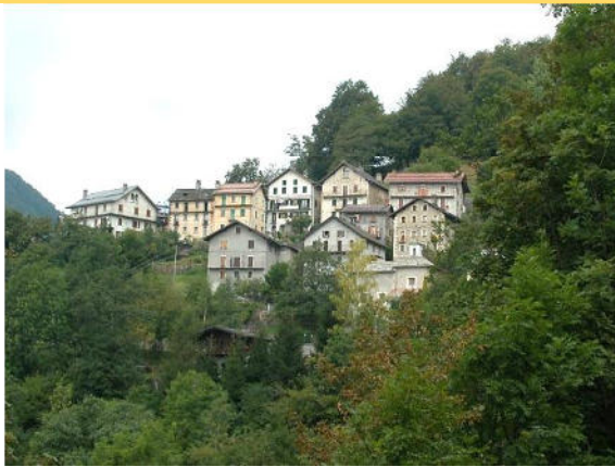
Fobello, frazione Costa, 1119 m s.l.m.: iso-orientamento e disposizione scalare delle case per garantire la migliore e più prolungata esposizione
